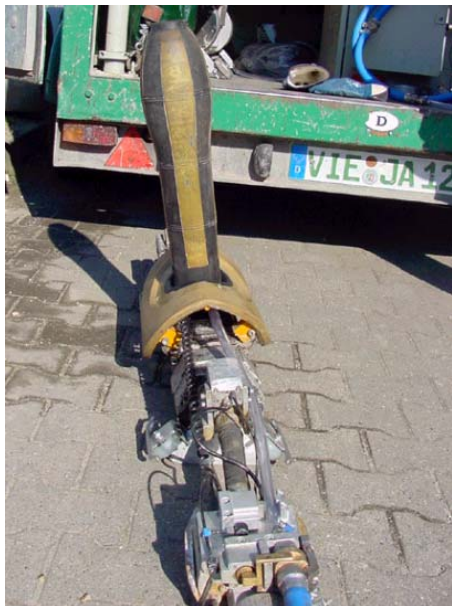
Abbildung 1: Injektionspacker mit Schalungsschild und Absperrblase
